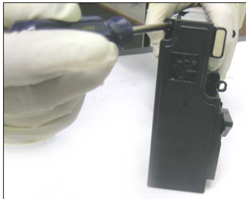
1. Retirar los dos tornillos que unen el depósito de desperdicios con el resto del cartucho.
