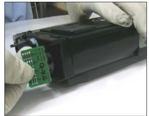
11. Sacar el chip como se muestra. Luego reemplazar por el nuevo Smartchip.
