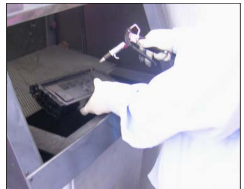
20. Limpie completamente el cartucho utilizando aire comprimido o aspiradora. Recargar el mismo con 245 gramos de toner y montar nuevamente siguiendo el orden inverso de arriba. Antes de instalar la tapa lado engranajes, efectuar la instalación del nuevo SmartChip.
