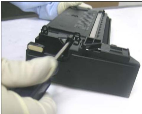
1. Retirar los dos tornillos que unen el depósito de desperdicios con el resto del cartucho.
