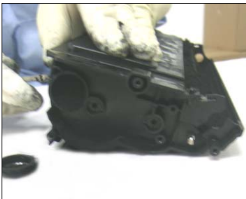
18. Por medio de una pinza de puntas largas retire la tapa de recarga de toner para vaciar y limpiar el deposito.
