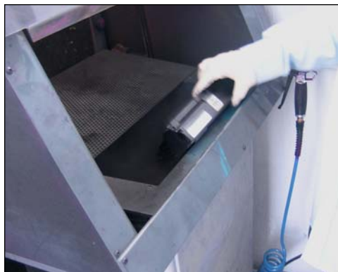
19. Golpear ligeramente el cartucho para vaciar el deposito.
