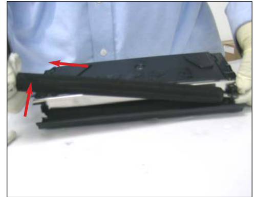
17. Levante y extraiga el rodillo como se muestra.
