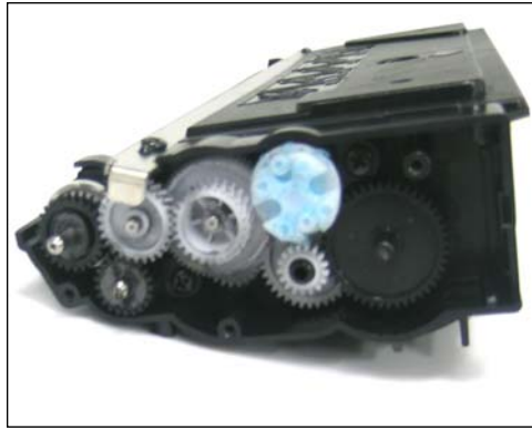
13. Extraiga el resto de los engranajes como se muestra.
